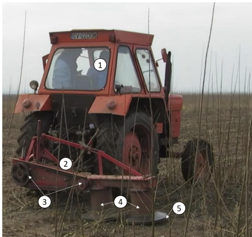
Fig. 8. Alcătuirea agregatului tractat pentru tăieri de lăstărire.
