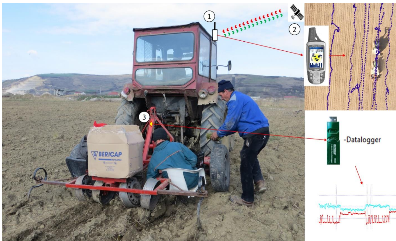
Fig. 7. Concept de monitorizare a performanței productive în operații de plantare. Legendă: 1 - unitate (receptor) GPS, 2 - constelație de sateliți, 3 - senzor de detectare a mișcării (vibrației).
